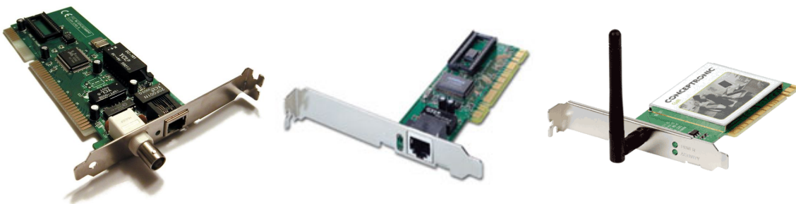
Figura 2.23. Tarxetas de rede. a) BNC, RJ45. b) RJ45. c) Inalámbrica (WiFi).
