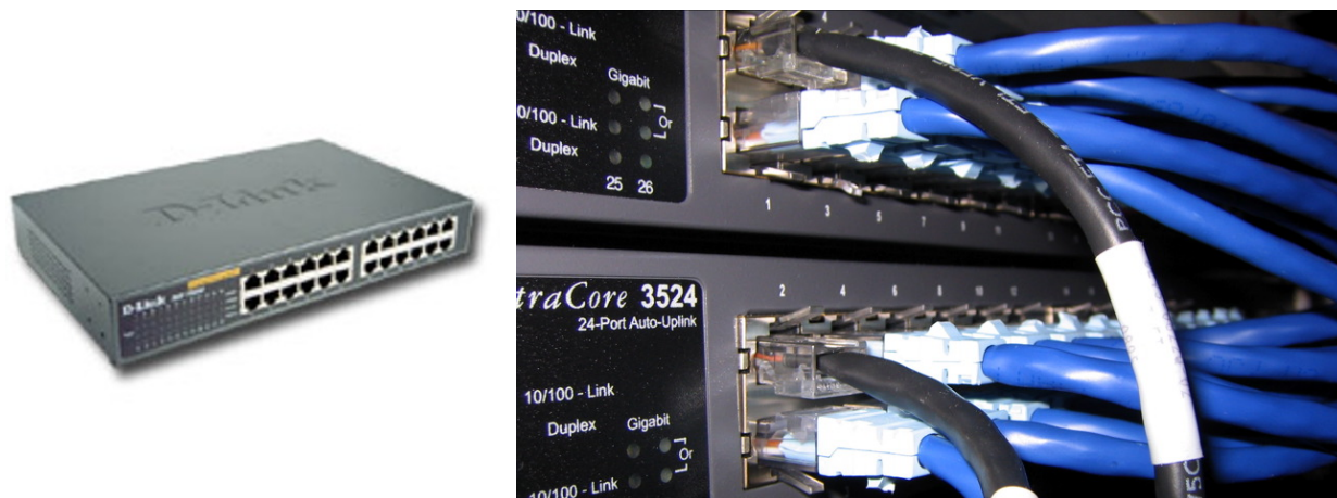
Figura 2.25. a) Switch D-Link. b) Conexións Ethernet en switch apilable.
